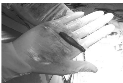
图 13 用手搓环氧腻子使处于合适硬度
